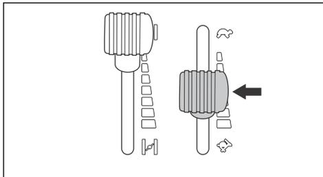
4. Si le moteur est froid, placez le starter complètement vers l'arrière.
