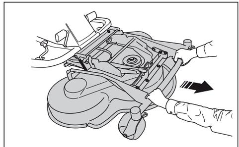
3. Soulevez le carter de coupe à la position verticale jusqu'à ce qu'un clic sonore se fasse entendre. Le carter de coupe est automatiquement verrouillé en position verticale.
