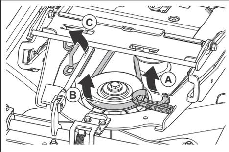
4. Tenez la poignée du ressort de la main gauche et retirez la courroie d'entraînement de la main droite.
