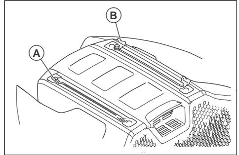
3. Faites passer la sangle à travers le support de rail (B) sur le côté opposé.
