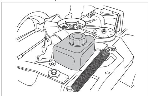
3. Remplissez avec de l'huile moteur si le niveau d'huile est en dessous de la ligne inférieure, mais ne remplissez pas au-delà de la ligne supérieure.
