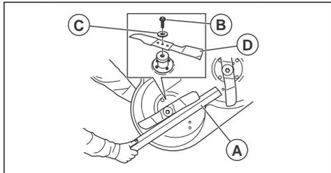
3. Desserrez et enlevez le boulon de la lame (B), les rondelles (C) et la lame (D).
