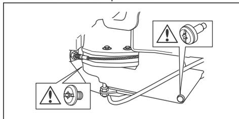
2. À l'aide d'un pistolet à graisse, lubrifiez au travers du graisseur du côté droit sous la poulie de courroie inférieure. Lubrifiez jusqu'à ce que de la graisse sorte de l'arrière du graisseur.
