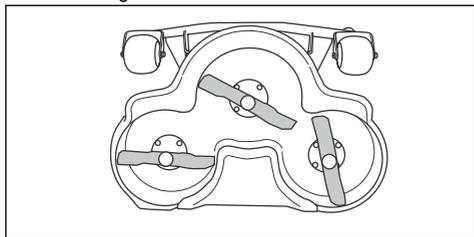
3. Serrez les boulons de lame à un couple de 45–50.
