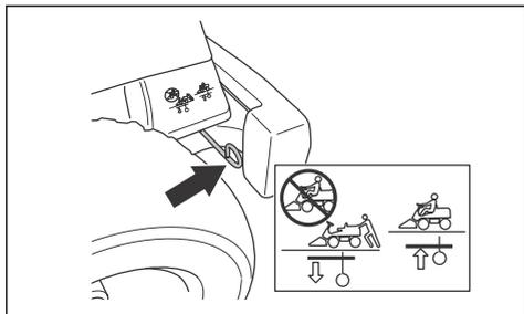
Le levier du système d'entraînement pour l'arbre avant de la R 316TX AWD, R 316TsX AWD se trouve derrière la roue avant gauche.
