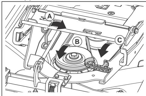
9. Placez la courroie d'entraînement autour de la roue de tension (B).
