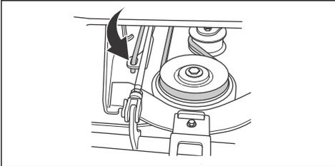
5. Placez la courroie d'entraînement autour des roues d'entraînement. Assurez-vous que la courroie d'entraînement est placée du bon côté de la roue de tension.
