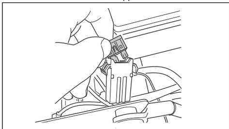
3. Remplacez le fusible grillé par un fusible neuf du même type, plat 20 A.
