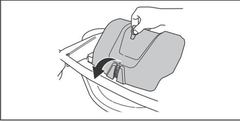
3. Relâchez la tension sur la roue de tension de la courroie d'entraînement. (A)
