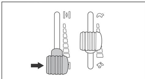
8. Poussez progressivement le starter vers l'avant jusqu'à sa position finale.
